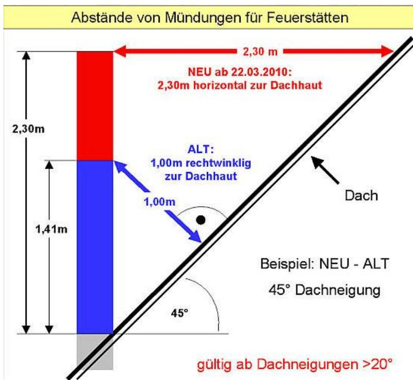
Mit steilerem Dach steigende Auswirkung auf die Schornsteinlänge.
